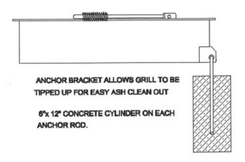
NOTE: THE SIZE OF THE CONCRETE FOOTING IS ONLY A SUGGESTION YOUR LOCAL SOIL CONDITIONS SHOULD DETERMIN WHAT IS NEEDED
